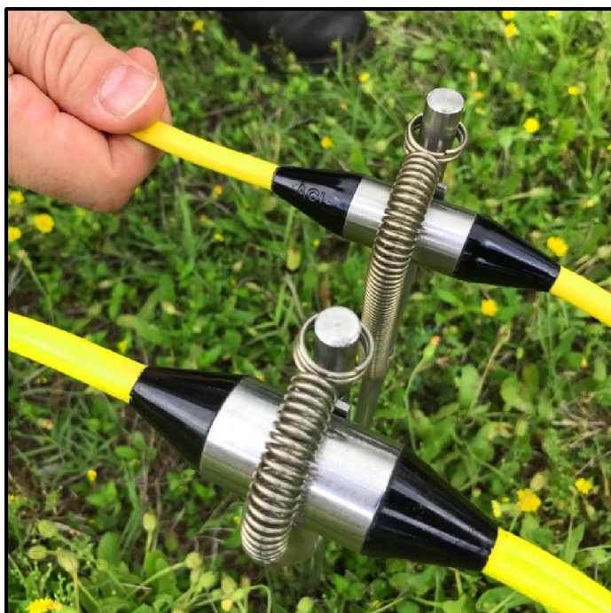
Slika 1: Kovinske elektrode s povezovalnim kablom za izvedbo meritev (vir: AGI USA).
